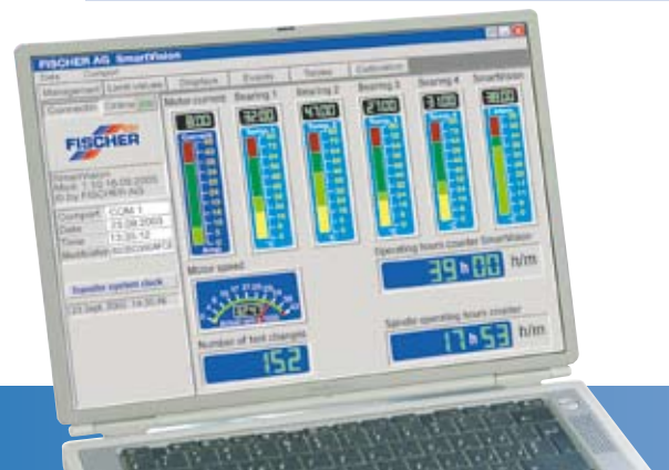
Dank dem von FISCHER PRECISE entwickelten Umrichter-System sowie dem Analyse- und Überwachungstool Smart Vision können prozessbegleitende Zustandsanalysen erfolgen.
